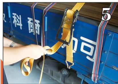
往返拉動棘輪以拉緊捆綁帶，直至貨物確實被繫緊。
