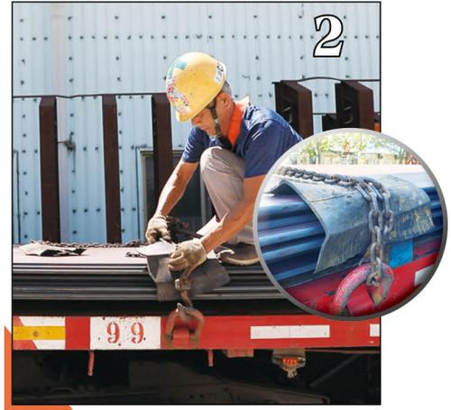
於鎖鏈及貨物間加裝護角以避免兩者摩擦而使鎖鏈斷裂或損傷。
