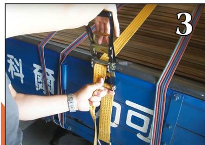
將棘輪短邊繩索之掛鉤勾住車側底板，確認捆綁帶無翻帶後將捆綁帶穿過卷軸送帶口。
