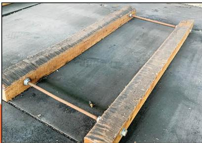
除捆綁工具、索具外，亦可使用防滑墊、支撐架、楔塊、木塊、枕木等工具來固定、防止貨物滑動，藉此達到緊固貨物之綜效。
