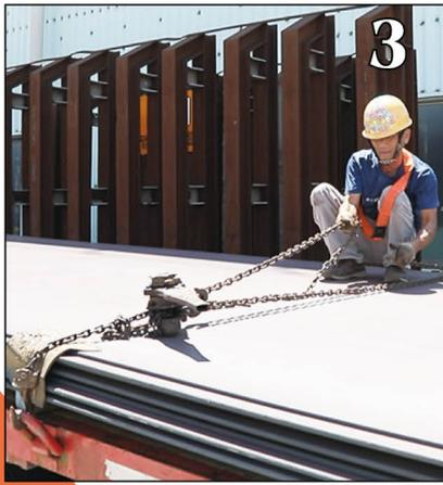
將鎖鏈固定於車輛另一側之固定鉤，並以鉤環將鎖鏈兩端連結固定。
