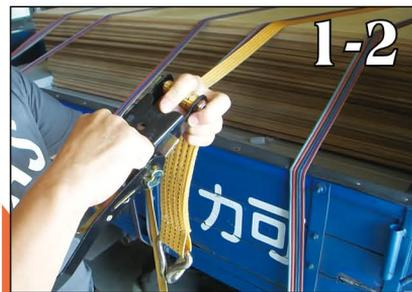
使用前先將安全扣拉住並將棘輪展開，展開後可先調整棘輪中心卷軸的送帶口方向，以利使用時方便將捆綁帶穿過卷軸。
