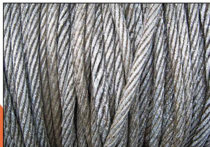
相較於前者，鋼索、鎖鏈等捆綁工具質量較重，適用於固定重型之貨物，如：鋼筋、鋼卷等。
