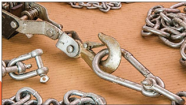
配合麻繩、捆綁帶、鎖鏈等捆綁工具使用，除能用於輔助繫緊貨物外，尚可提供捆綁工具強化之固定點，使貨物更加緊固。
